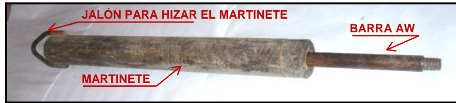
FIGURA 3.- MARTINETE DE SEGURIDAD, DE 63.5 kg DE MASA, DE 76 cm DE CAÍDA LIBRE
