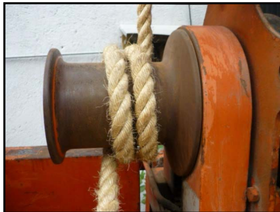
FIGURA 5.- CUERDA ENROLLADA EN SENTIDO CONTRARIO A LAS MANECILLAS DEL RELOJ, CON 2.25 VUELTAS FUENTE: NORMA D 1586 – 84 DE LA ASTM
